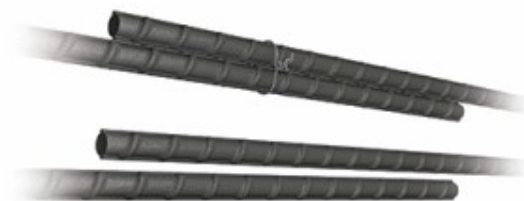
شکل ۷-۱۶ وصله پوششی تماسی و وصله پوششی غیر تماسی
